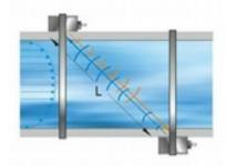
Здесь время прохождения сигнала по направлению потока t1 меньше времени прохождения сигнала против потока t2. Разница между этими временами пропорциональна средней скорости потока вдоль луча измерения vm. NivuFlow Mobile 600 рассчитывает среднюю скорость потока vA исходя из измеренных скоростей по лучам vm.
