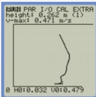
Отображение графика распределения скоростей потока на экране расходомера в реальном времени
